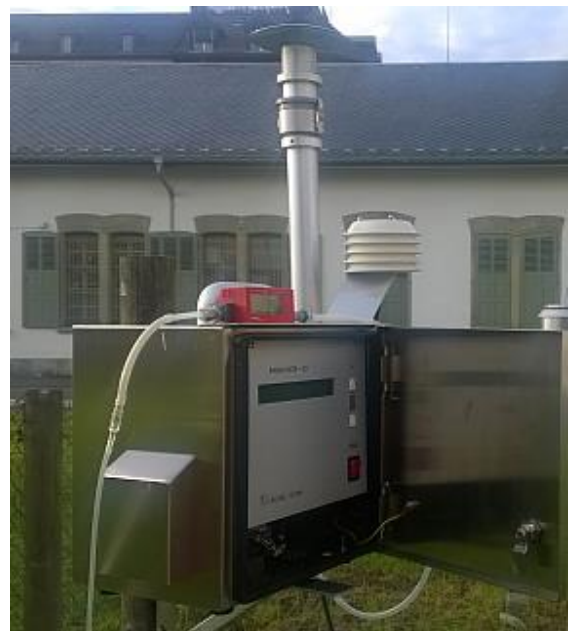
Abb. 2: Durchflusskalibrierung an einem Minivolumesampler
