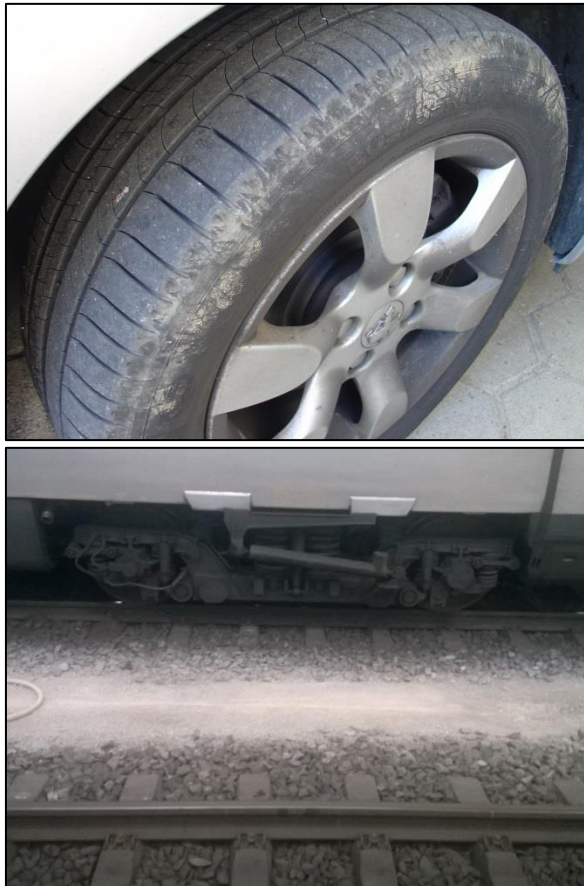
Abb. 1: Oben: Detailbild eines Pneus mit gut sichtbarem Strassenabrieb und Staub. Unten: Bild eines Eisenbahngleises, wo die Interaktion zwischen Rädern, Bremsen und Schienen zu erkennen ist.
