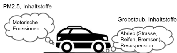
Abb. 3: Schematische Skizze der Verkehrs-Emissionen und der immissionsseitigen Messstrategie
